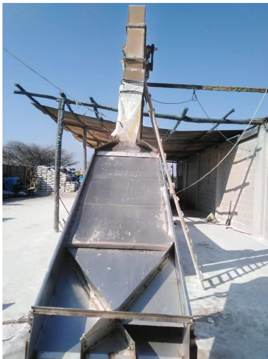
Figura 13. Tamizador de la empresa Gemar Group E.I.R.L Fuente: Gemar Group E.I.R.L
