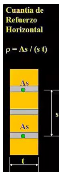
Imagen 24. Ilustración del refuerzo horizontal en los muros
