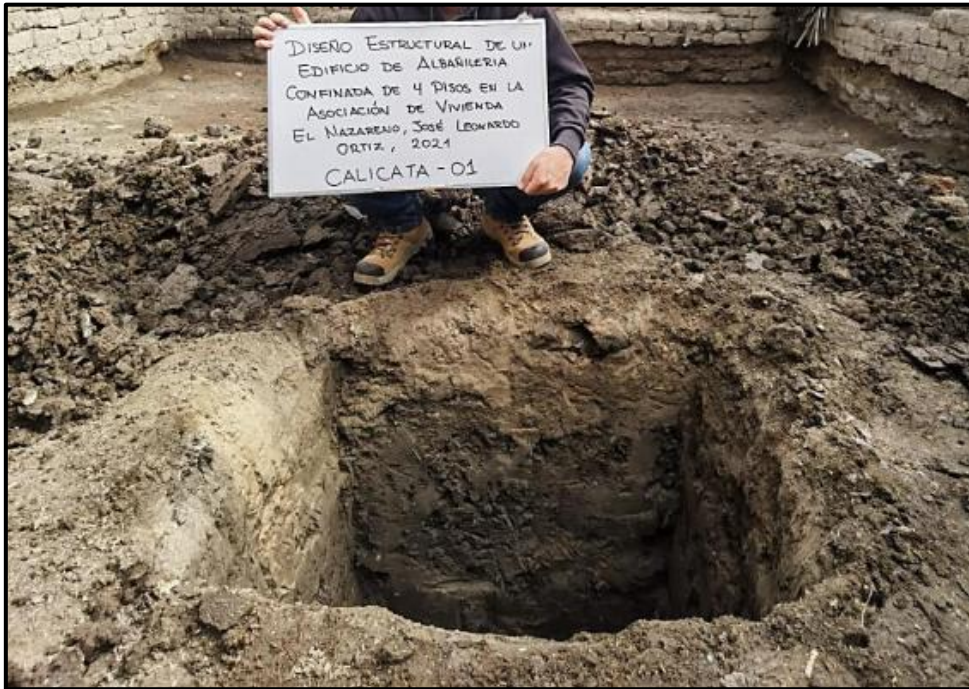
Imagen 53. Vista general del perfil estratigráfico de la calicata C-01 del estudio de mecánica de suelos
