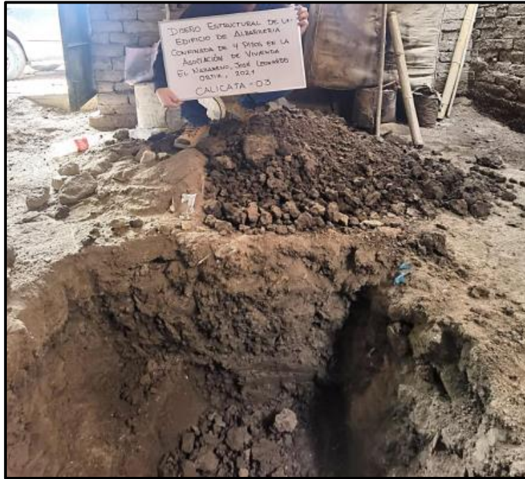
Imagen 55. Vista general del perfil estratigráfico de la calicata C-03 del estudio de mecánica de suelos
