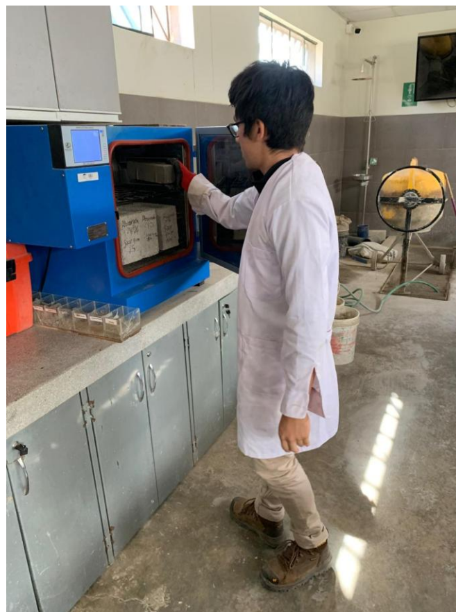
Fig. 122. Ingreso de adoquines al horno para obtener peso seco.
