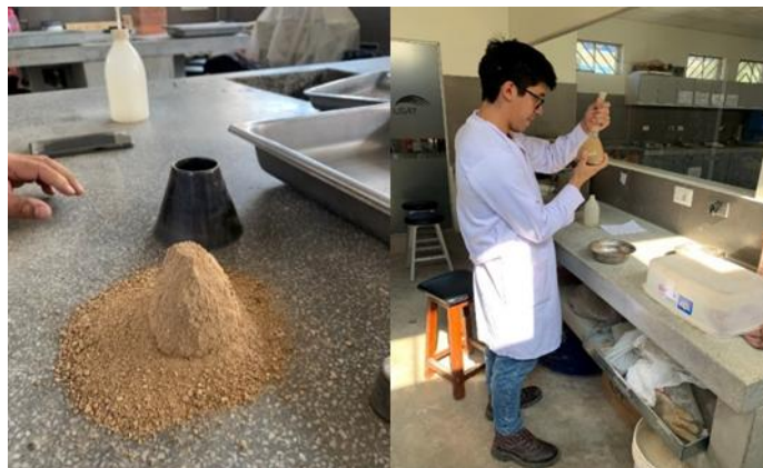
Fig. 27. Condición SSS – Eliminación de burbujas de aire.
