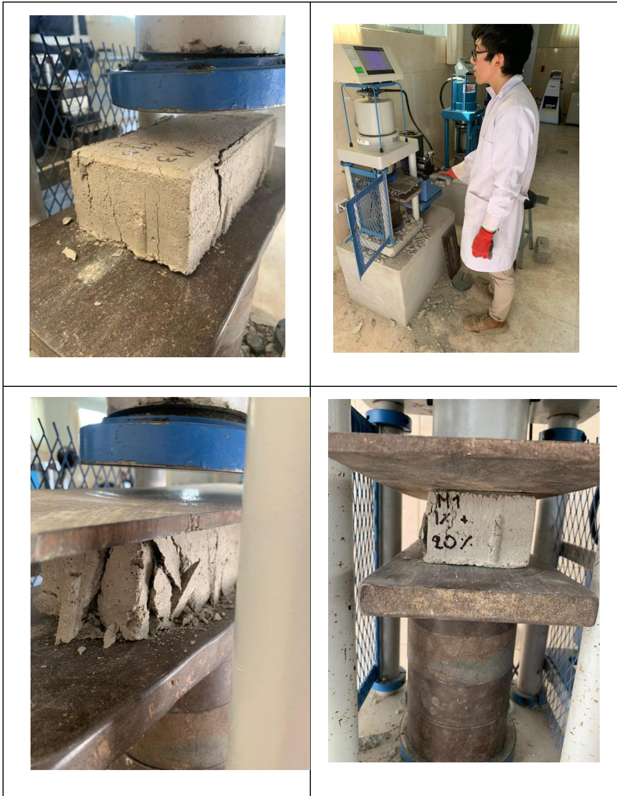
Fig. 130. Ensayo de resistencia a la compresión.
