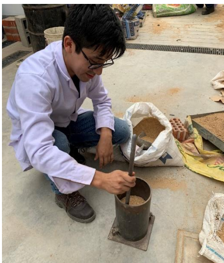
Fig. 32. Compactado del agregado fino.
