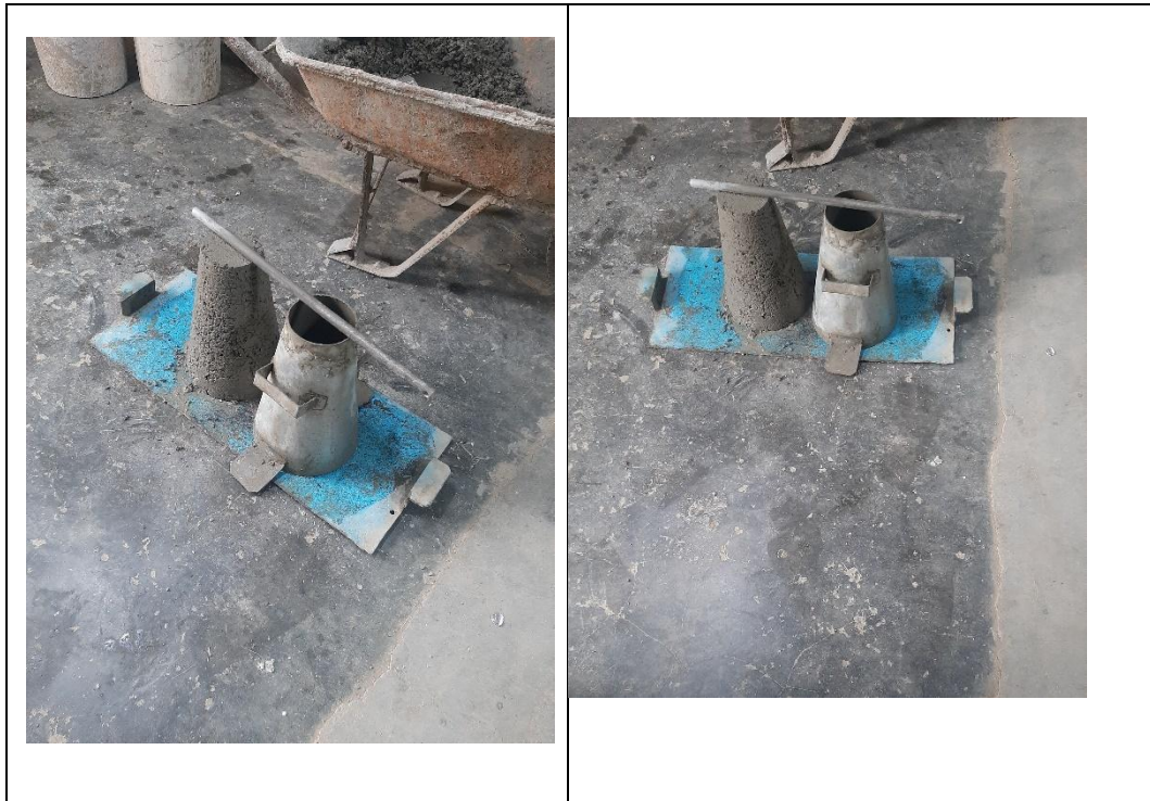
Fig. 115. Determinación de revenimiento (Slump).
