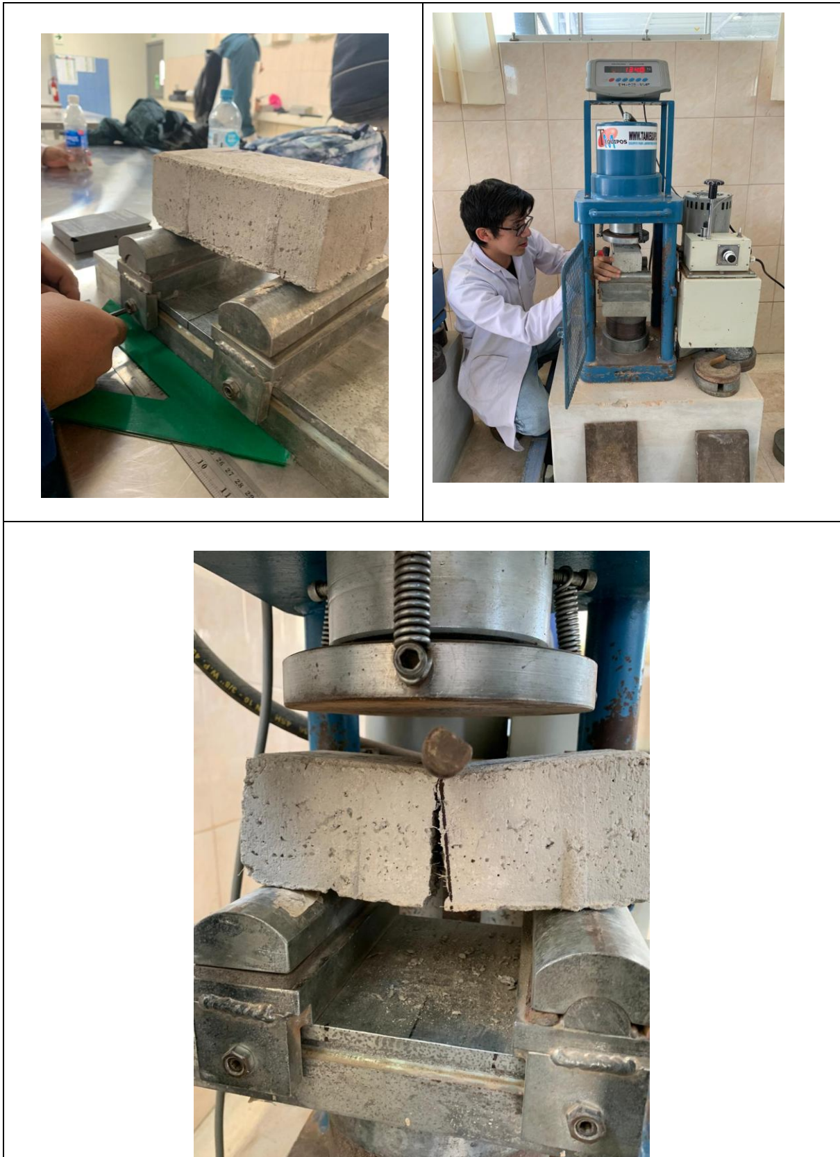
Fig. 134. Ensayo de resistencia a la flexotracción.
