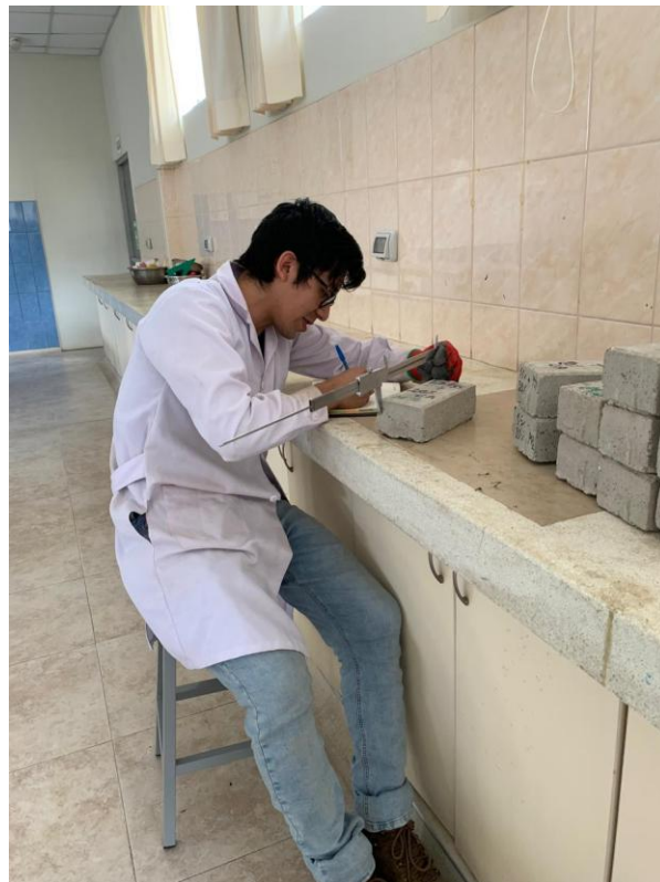
Fig. 126. Toma de longitudes del adoquín.
