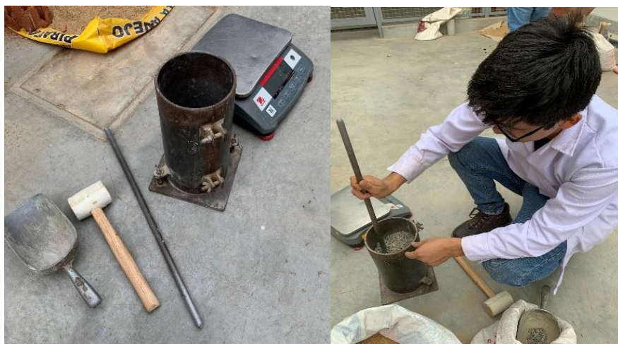
Fig. 31. Equipos y compactado del agregado grueso.
