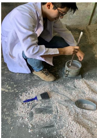
Fig. 39. Compactado de las capas de la muestra de CA.
