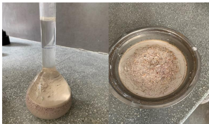
Fig. 37. Muestra saturada después de 24h y después de 24h en el horno.
