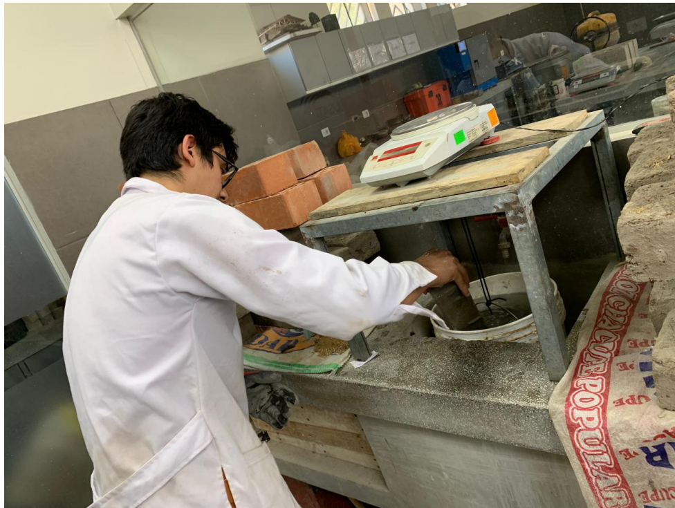
Fig. 121. Peso saturado y sumergido.
