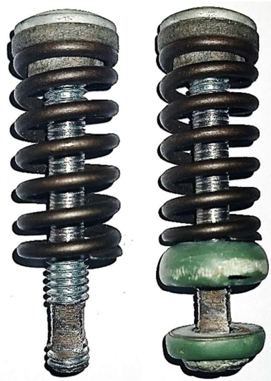
Figura 35. Resorte y perno de 3/8" y arandelas modificados.
