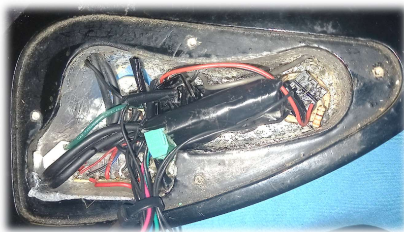
Figura 32. Cavidad del instrumento en donde se aloja la electrónica del mismo además del circuito del dispositivo propuesto recubierto en cinta aislante.
