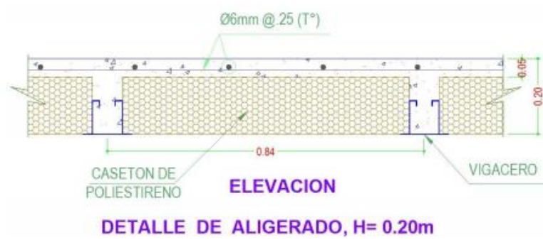
Figura 16 Detalle de la losa con viguetas prefabricadas
