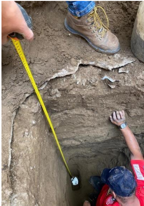
Fotografía 8. Profundidad en cual se encuentra el nivel freático
