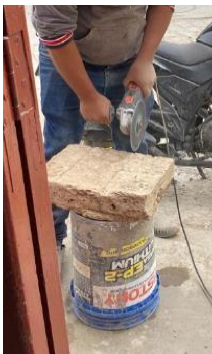
Fotografía 17. Unidad de adobe siendo cortado con amoladora para obtener 3 bloques de adobe
