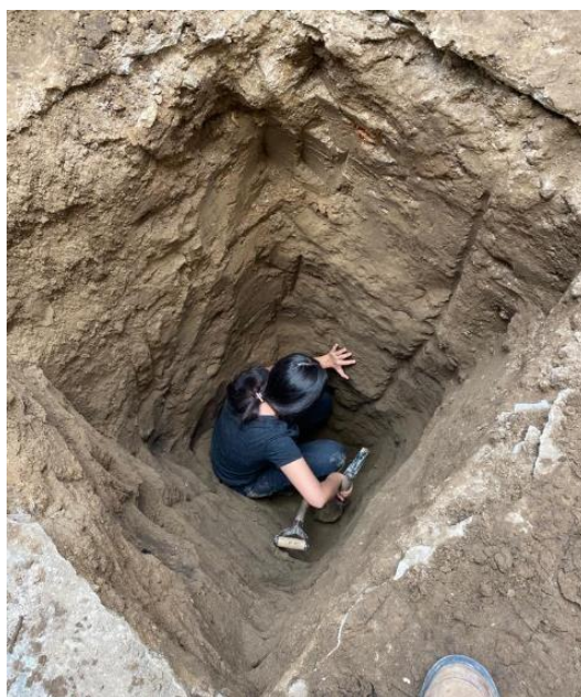
Fotografía 7. Verificación del nivel freático
