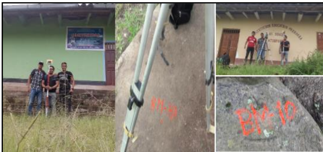
Fotografía N°: 4 Bm colocados en en levantamiento topografico
