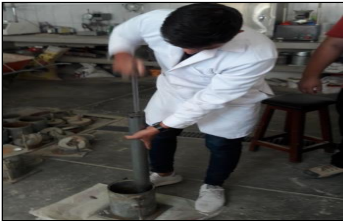
IMAGEN N°5.16: ENSAYO DE CBR
